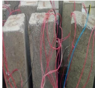
ب) نمایی از مدار الکتریکی برای ایجاد خوردگی تسریع شده
