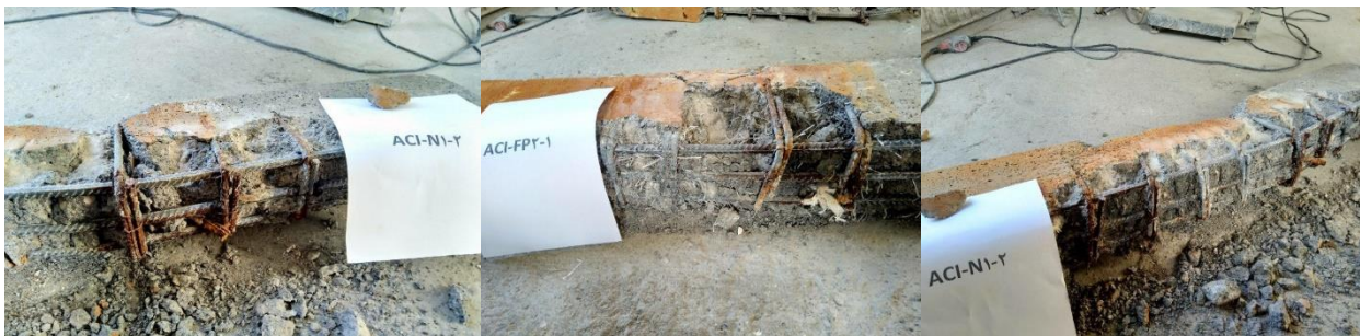
شکل ۵- شمایی از توزیع میزان خوردگی در نمونه‌های آزمایشگاهی
