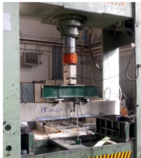
الف) بارگذاری و ابزاربندی آزمایش در آزمایشگاه
