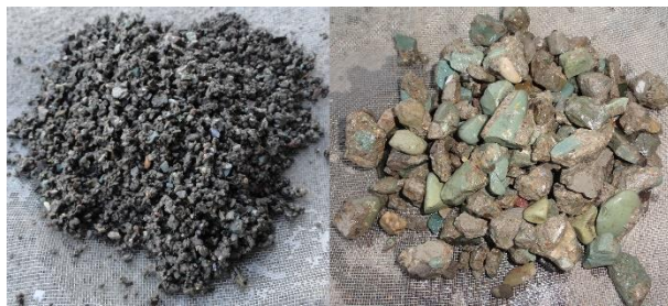
شکل ۳- درشت‌دانه و ریزدانه بازیافتی الف: درشت‌دانه، ب: ریزدانه
