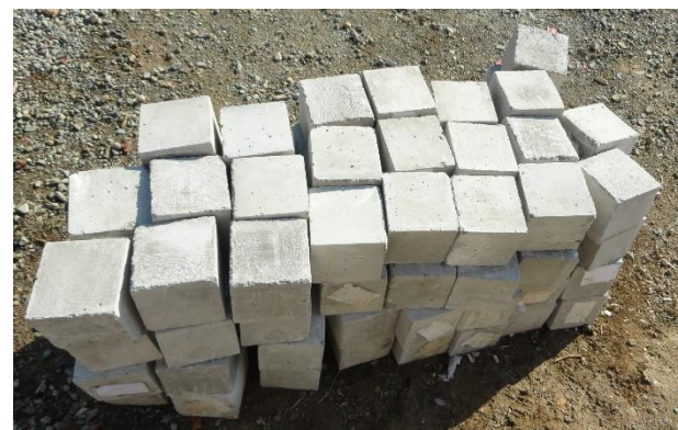
شکل ۱- زباله‌های بتنی مورد استفاده جهت تهیه سنگ‌دانه بازیافتی
