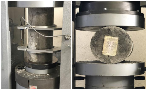
شکل ۵- آزمایش‌های مقاومت فشاری و کششی
