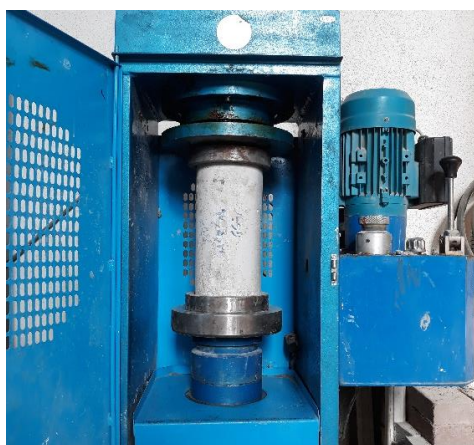
شکل ۷- نمونه بتنی استوانه ای در حین آزمون فشاری
