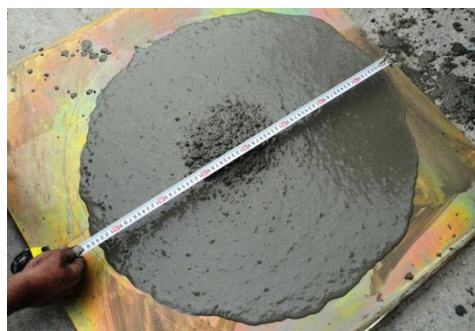
شکل ۴- آزمایش جریان اسلامپ برای بتن خودتراکم
