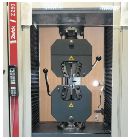
شکل ۸- نمونه کششی استاندارد در حین آزمون کشش
