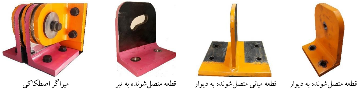
شکل ۳- ساختار میراگر اصطکاکی مورد مطالعه و قطعات تشکیل دهنده آن
