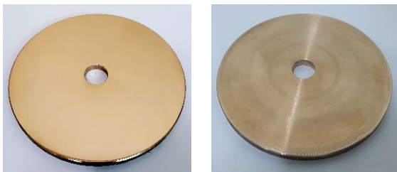
شکل ۲- دیسک اصطکاکی فسفر-برنز با قطر ۱۲۰ میلی‌متر (الف) قبل از پولیش (ب) بعد از پولیش
