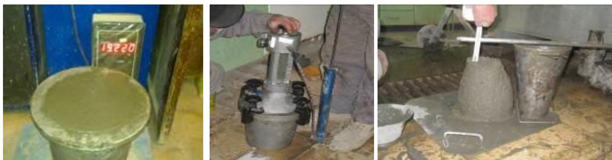
شکل ۲- آزمایش‌های بتن تازه (از راست به چپ: تعیین اسلامپ، هوای کل و چگالی)
