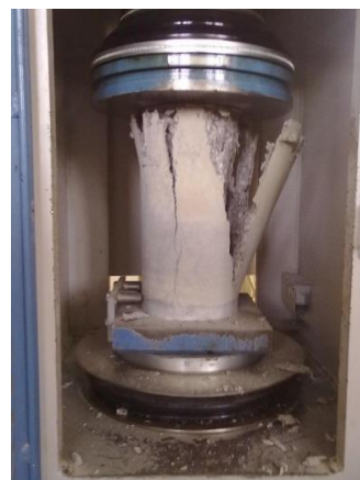
شکل ۶- نمونه شاهد خرد شده در دستگاه فشار محوی بتن
