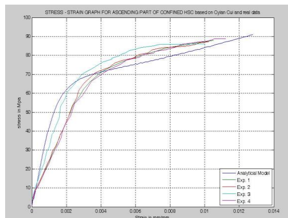
شکل ۱۳- مدل تحلیلی برای نمونه ها با یک لایه پوشش فیبر کربن
