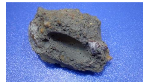
(ج) درشت‌دانه بازیافتی حاصل از ملات سیمانی قدیمی شکل ۳- حالت‌های مختلف تشکیل سنگدانه‌های بتنی بازیافتی
