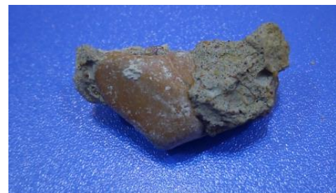
(الف) درشت‌دانه بازیافتی حاوی درشت‌دانه طبیعی و ملات چسبیده
