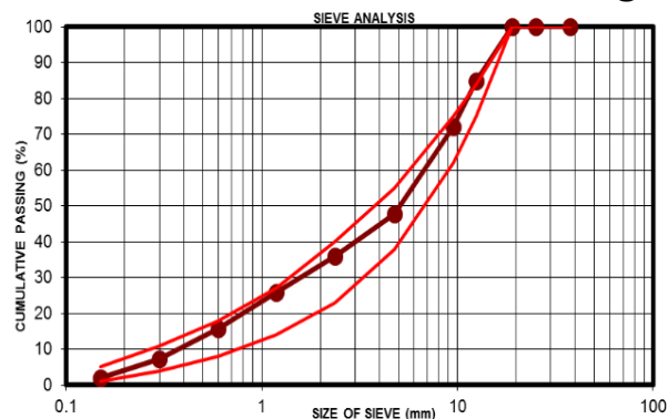
شکل ۱- منحنی دانه‌بندی سنگدانه‌های مصرفی در نسبت مخلوط بتن معمولی
