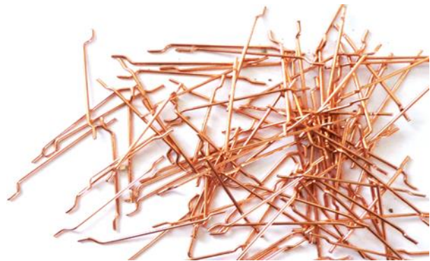
شکل ۲- الیاف فولادی دو سر قلاب‌دار
