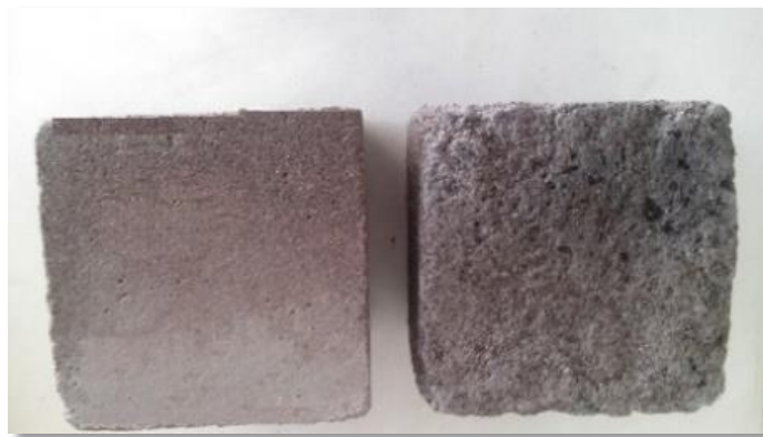
شکل ۵- نمونه بتن L1 و L10 بعد از آزمایش خوردگی
