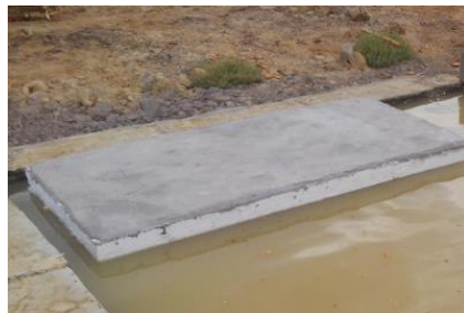
شکل ۱۱- آستر بتنی بر روی سه نمونه از راست به چپ: یونوبتن، فومتالات و یورتالات
