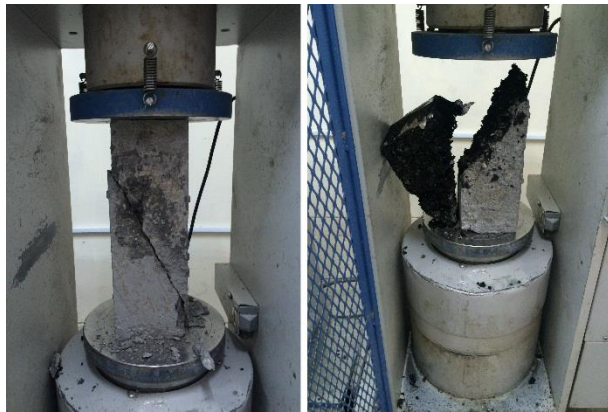
شکل ۸- میزان باربری اتصال آزمون‌های مرکب طی آزمایش برش سطح مورب با روکش بتنی و آسفالتی
