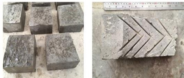
شکل ۳- سطح نیمه بتن غلتکی نمونه‌های مرکب
