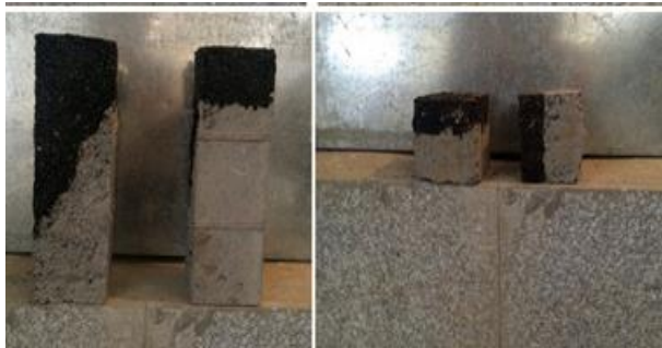
شکل ۴- نمونه‌های مرکب بتن غلتکی همراه با لایه روکش
