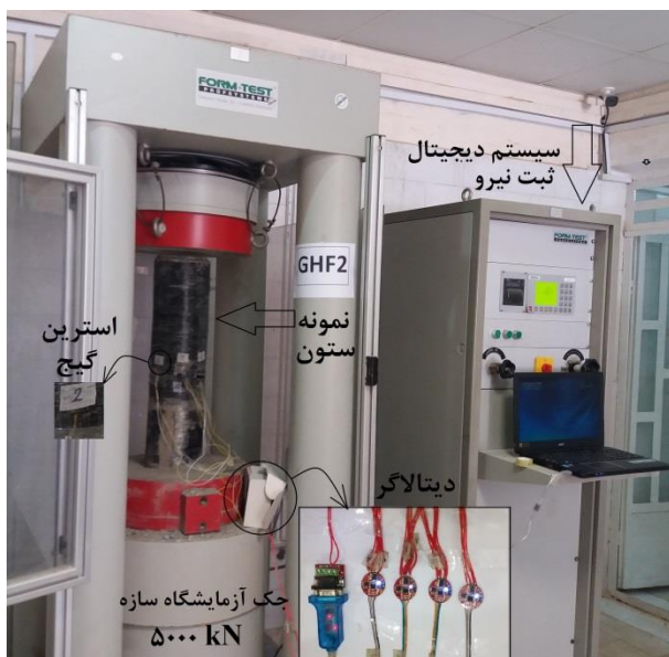
شکل ۷- نحوه نصب دستگاه آزمایش جهت بارگذاری نمونه‌ها
