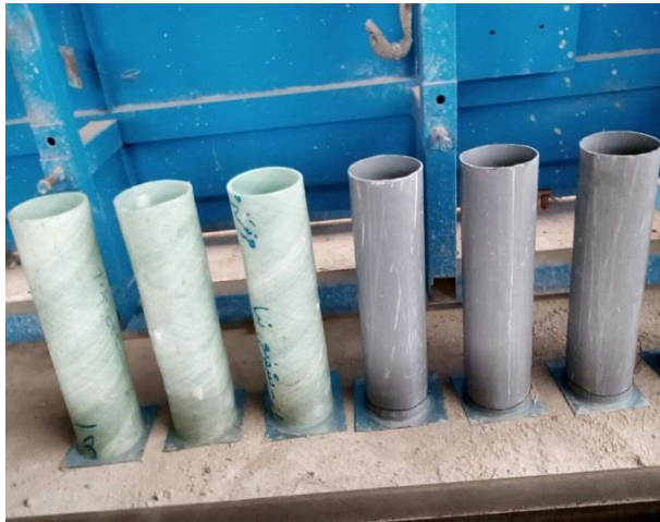
شکل ۳- لوله‌های GRP و قالب‌های PVC
