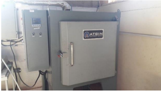
الف) نمای روبروی کوره الکتریکی
