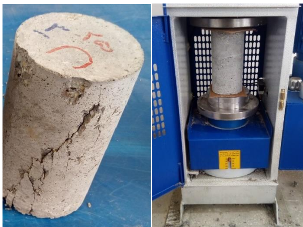
الف) نحوه ی قرارگیری نمونه (ب) نحوه ی شکست نمونه ها در زیر جک پس از آزمایش مقاومت فشاری شکل ۱۰- آزمایش مقاومت فشاری نمونه ها
