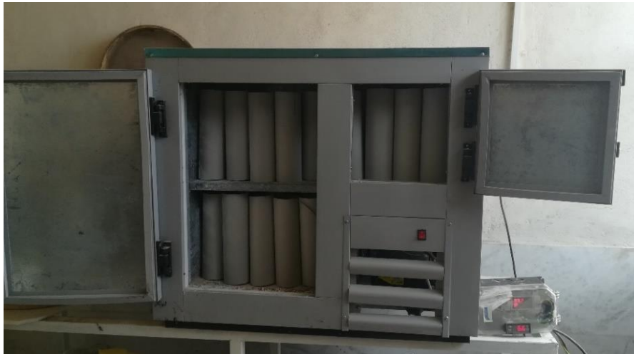
شکل ۳- دستگاه اتوماتیک انجام چرخه های ذوب و یخبندان
