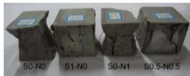
شکل ۷- تفاوت در مود شکست فشاری نمونه‌ها
