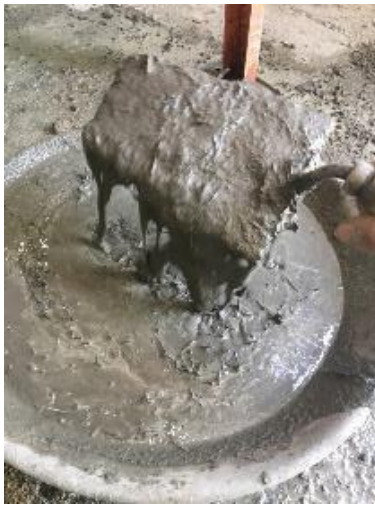
شکل ۴- شکل ظاهری بتن تازه توانمند الیافی
