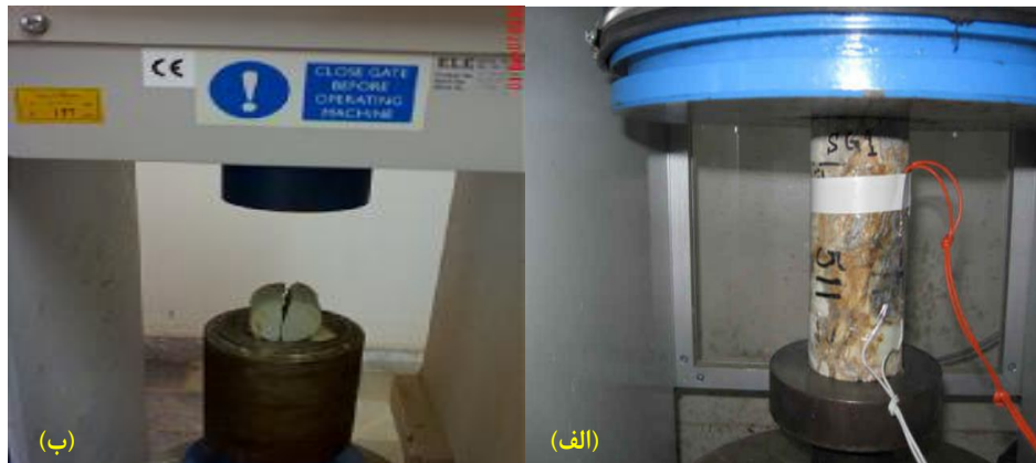
شکل ۱- الف) نمونه‌ای از انجام آزمایش فشاری و ضریب ارتجاعی، ب) نمونه سنگ آهن شکسته شده پس از آزمایش مقاومت کشش برزیلی
