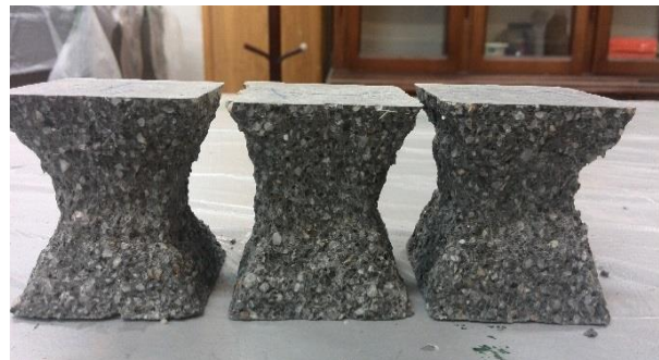
شکل ۱- نمونه‌های شکسته شده تحت آزمایش فشاری
