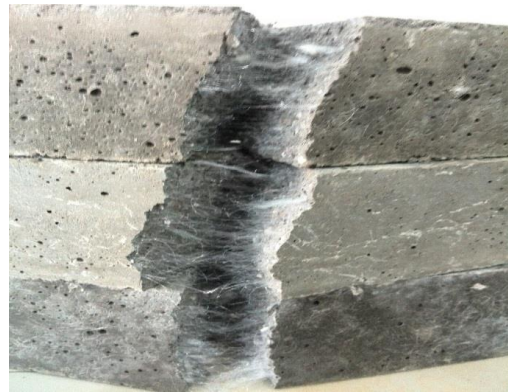
شکل ۱۴- نمونه‌های شکسته شده تحت آزمایش خمش
