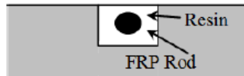
شکل ۵- شیار بتن و قرار گیری اپوکسی در روش NSM
