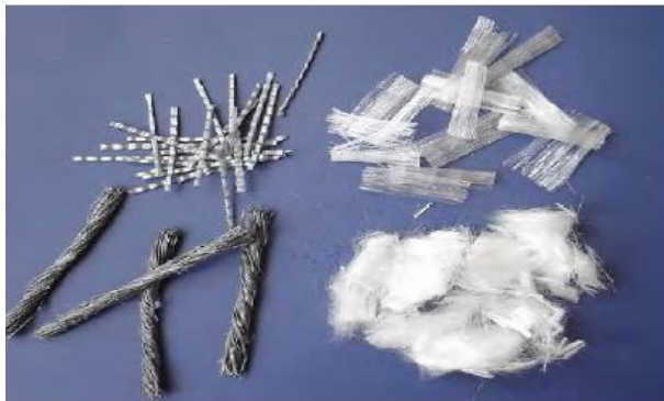
شکل ۳- الیاف پلی پروپیلن مورد استفاده در بتن با هندسه‌های مختلف
