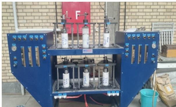
شکل ۲- شمای کلی دستگاه نفوذپذیری و نمونه‌های تحت آزمایش نفوذ آب
