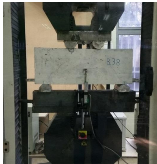
شکل ۴- بارگذاری تیرها در آزمایشگاه
