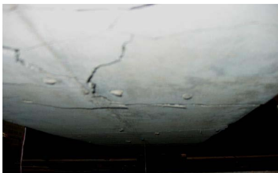
شکل ۱۳- ترک خوردگی طولی زیر تیر در اثر چرخش وصله BarSplice بر روی نمونه B
