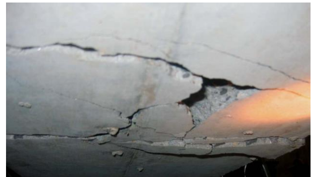
شکل ۱۵- ترک خوردگی طولی زیر تیر در اثر چرخش وصله QuickWedge بر روی نمونه B (جهت امتداد طول تیر)
