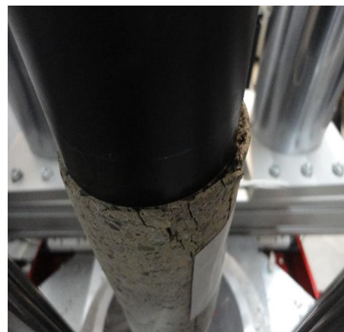
شکل ۱۳- نحوه‌ی شکست مغزه‌ی B5
