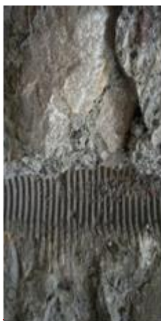
(ت) اثر تغییر پیچ میله روی بتن
