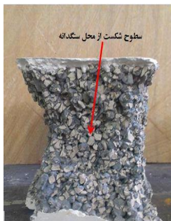
شکل ۵- نمونه ترک خورده بتنی با سنگ دانه آهکی
