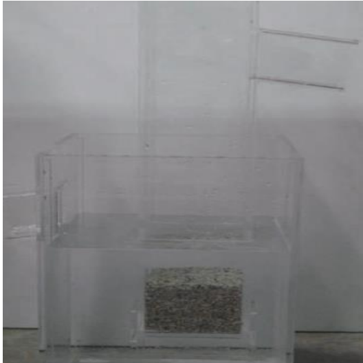
شکل ۳- تجهیزات جهت انجام آزمایش نفوذپذیری
