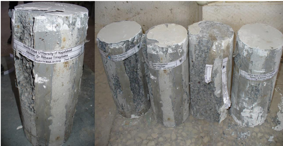
شكل ۵- عدم جداشدگي ميلگرد از سطح بتن
