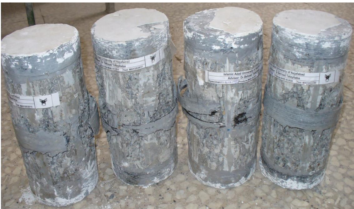
شكل ۶- پارگي ورق‌هاي FRP
