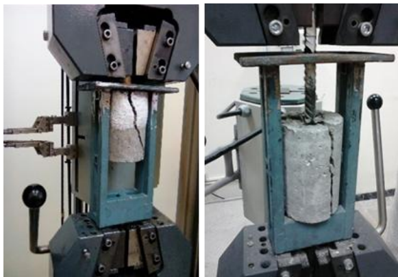
شکل ۲- آزمایش بیرون کشیدگی میلگرد از بتن
