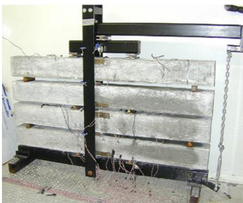
(ح) بتن مسلح با میلگرد FRP تحت خمش و سیکل یخ زدن
