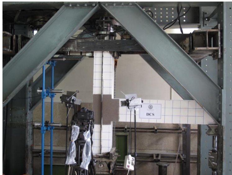
شکل ۴- سیستم تکیه گاهی و دستگاه بارگذاری
