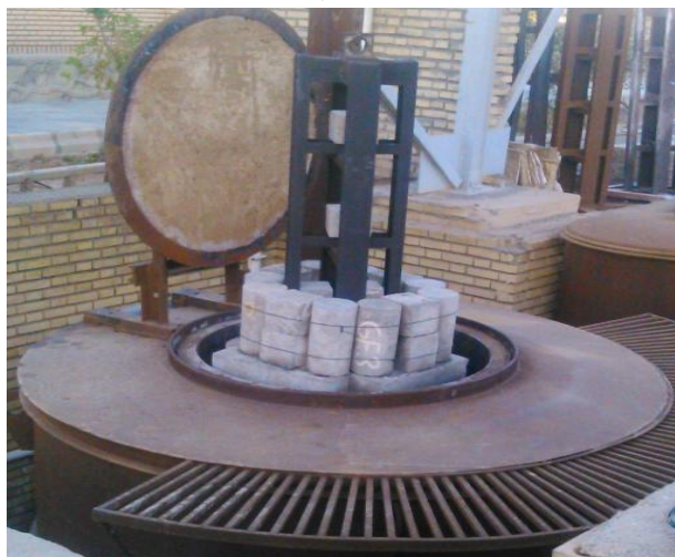
شکل ۳- کوره‌ی مورد استفاده برای اعمال حرارت
