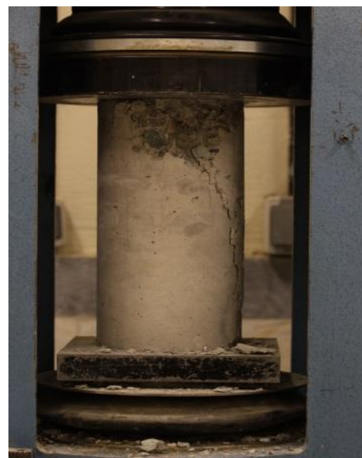
شکل ۴- آزمایش مقاومت فشاری تک محوری
