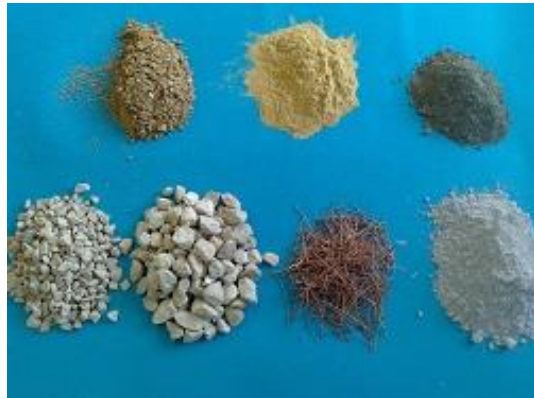
شکل ۳- مصالح مورد استفاده در ساخت بتن الیاف فلزی
