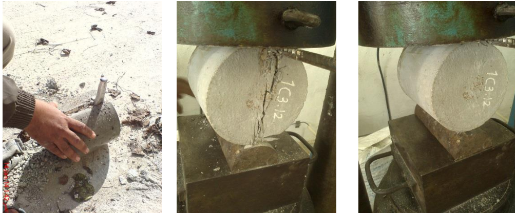
شکل ۸- نحوه شکافتن بتن‌های الیافی (از راست به چپ)
