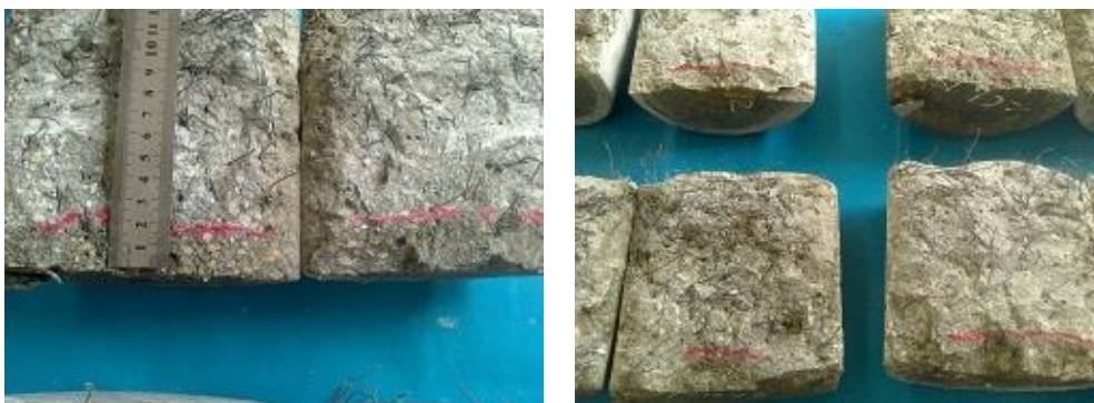
شکل ۱۰- اندازه‌گیری عمق نفوذ آب در نمونه‌های بتن الیافی
