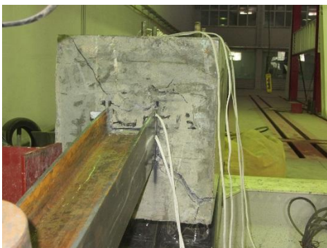
د: نحوه توزیع ترک در نمونه شماره ۲ (نمای روبرو)
