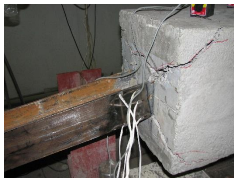
ح: نحوه خمش تیر در نمونه شماره ۱
