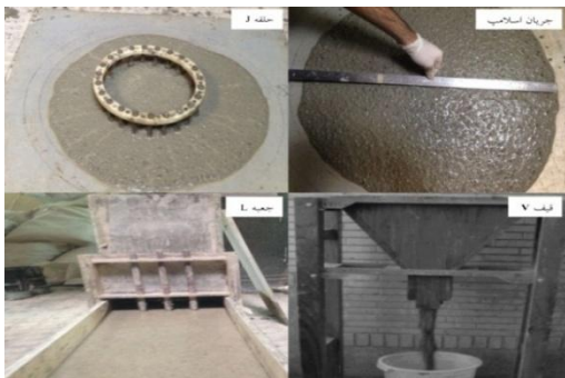
شکل ۲- آزمایشات فاز خمیری بتن خودتراکم
