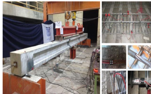
شکل ۱- تصویری از ابزاربندی پایش و آزمایش بارگذاری تیر
