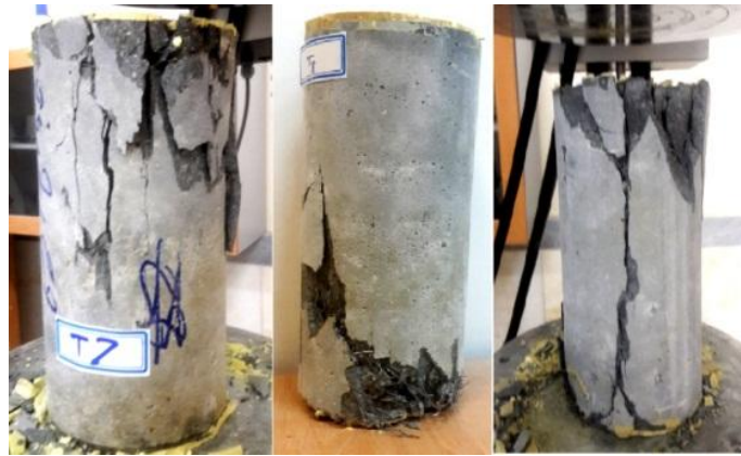
شکل ۹- الگوی ترک خوردگی فشار تک‌محوری استوانه‌ای (نمونه UXC-H)
