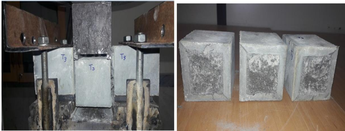
شکل ۱۴- نمونه از مقطع شکست HPCFRCC در آزمایش برش بر اساس JSCE-G
