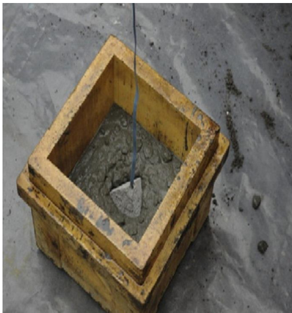
شکل ۱۳: آماده سازی برای اندازه گیری مقادیر دما و رطوبت در لحظات اولیه ی شکل گیری بتن توسط سنسور SHT21S در داخل مکعب
