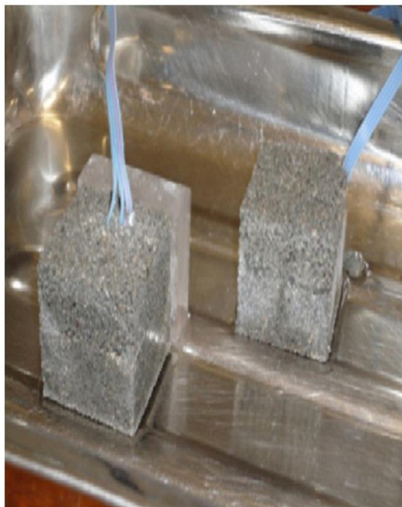
شکل ۱۲: چیدمان اندازه‌گیری رطوبت و دما با استفاده از سنسور SHT15 با کمک مکعب سیمانی محافظ
