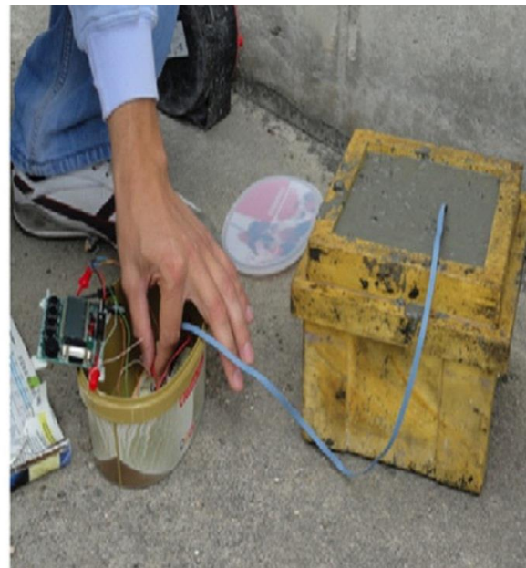
شکل ۱۳: آماده سازی برای اندازه گیری مقادیر دما و رطوبت در لحظات اولیه ی شکل گیری بتن توسط سنسور SHT21S در داخل مکعب
