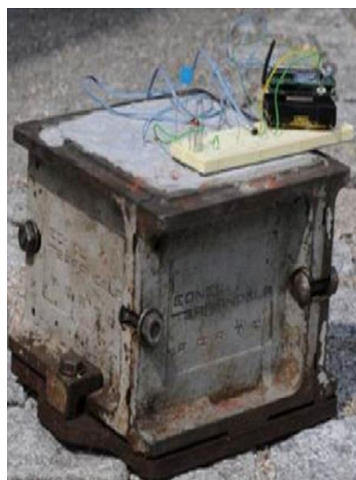
شکل ۲: اندازه‌گیری دما توسط سنسور بی‌سیم در داخل مکعب بتنی
