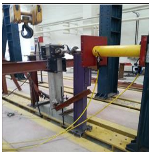
شکل ۳- نحوه‌ی اعمال بارگذاری بر روی نمونه
