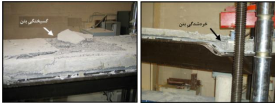
شکل (۶): نحوه گسیختگی تیر کامپوزیتی در آزمایشگاه [۱۷]
