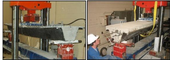
شکل (۲): نحوه بارگذاری استاتیکی، (الف) نمونه با دال بتنی، (ب)
