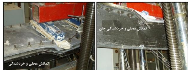
شکل (۱۱): گسیختگی نمونه آزمایشگاهی تیر فاقد دال بتنی [۱۷]
