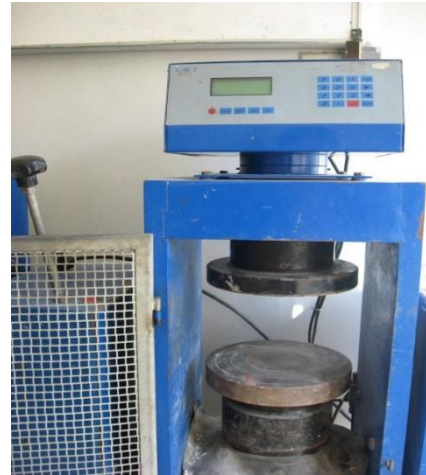
شکل ۴- دستگاه بتن شکن جهت تست فشاری
