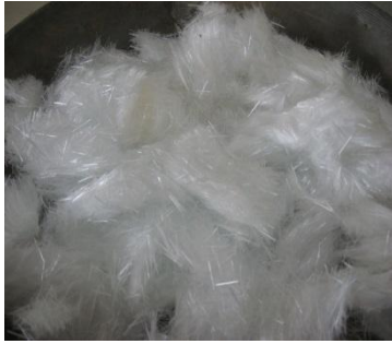
شکل ۲- الیاف فیبر شیشه‌ای توزین شده برای طرح اختلاط
