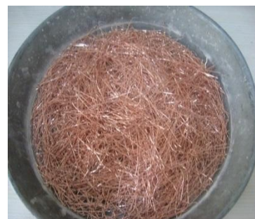
شکل ۱- الیاف فولادی توزین شده برای طرح اختلاط [۹].
