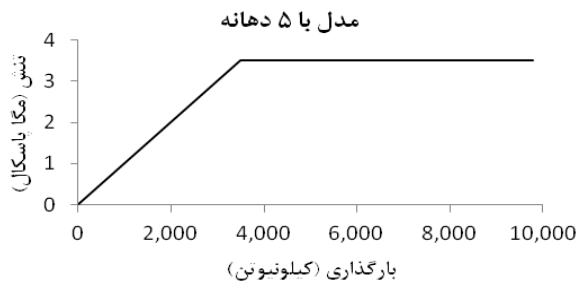
شکل ۹: میزان تنش در کلید قوس پل اکبرآباد تا نقطه تسلیم [۱۲].
