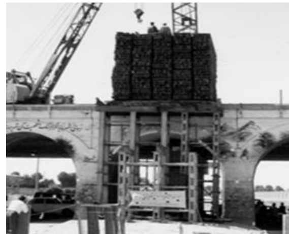
شکل ۲- بارگذاری استاتیکی پل اکبرآباد [۱۹]
