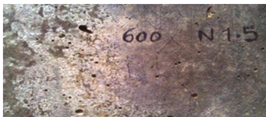
شکل ۱۵-ب- بتن LWN1.5 در دمای ۶۰۰ درجه سانتیگراد
