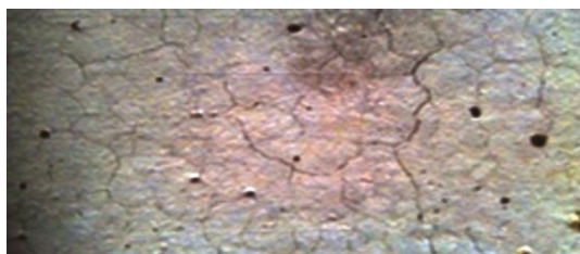
شکل ۱۴- سطح ظاهری بتن LWplain در دمای ۶۰۰ درجه سانتیگراد
