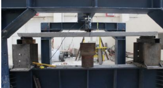
شکل ۹- آزمایش خمش سه نقطه ای
