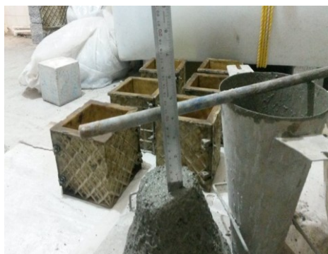
شکل ۸- آزمایش اسلامپ بر روی بتن تازه
