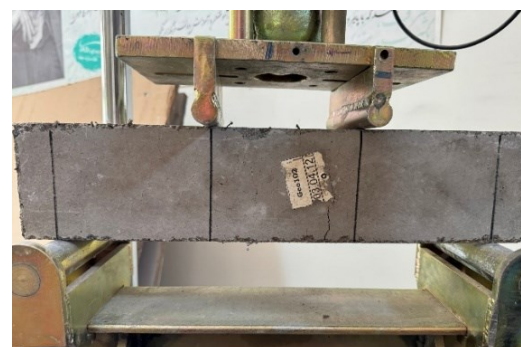
شکل ۵- آزمایش مقاومت خمشی، همراه با نمایش ترک‌های مشاهده شده در یک سوم میانی دهانه
