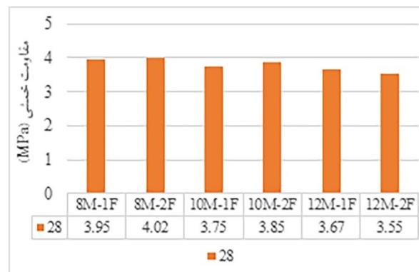
شکل ۱۱- نتایج آزمایش مقاومت خمشی
