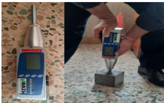
شکل ۱۱- چکش اشمیت مورد استفاده و آزمایش چکش اشمیت بر روی نمونه مکعبی بتن خودتراکم سنگین
