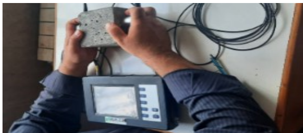
شکل ۸- نحوه اندازه‌گیری سرعت پالس در آزمایش التراسونیک در یک نمونه بتن خودتراکم
