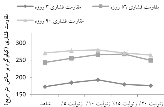
شکل ۸. مقایسه تغییرات در مقاومت فشاری نمونه‌های کربناته با درصد‌های مختلف زئولیت برای سنگ‌دانه کلسیت
