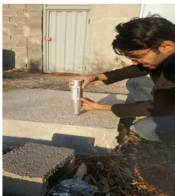
شکل ۶- بالا: میانگین عدد بازگشت چکش اشمیت نمونه‌ها برای طرح‌های مختلف اختلاط؛ پایین: آزمایش چکش اشمیت بر روی دال‌های مکعبی
