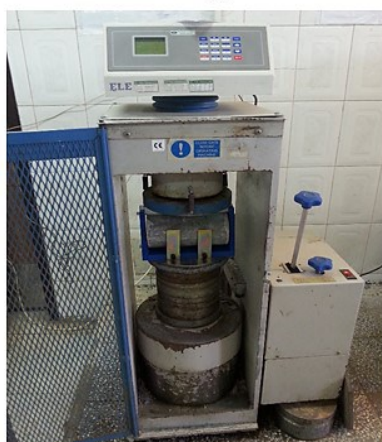
شکل ۴- بالا: مقایسه میانگین مقادیر مقاومت کششی نمونه‌ها در سه طرح اختلاط مختلف؛ پایین: آزمایش برزیلی بر روی نمونه‌های استوانه‌ای استاندارد
