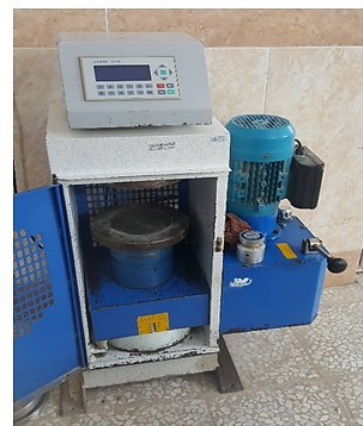
شکل ۳- بالا: مقایسه میانگین مقاومت فشاری تک‌محوره نمونه‌ها در سه طرح اختلاط مختلف؛ پایین: دستگاه آزمایش مقاومت فشاری تک‌محوره بر روی نمونه مکعبی
