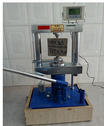
شکل ۵- بالا: مقایسه میانگین مقادیر شاخص بار نقطه ای نمونه‌ها برای طرح‌های مختلف اختلاط؛ پایین: دستگاه آزمایش شاخص بار نقطه ای بر روی آزمونه‌های مکعبی
