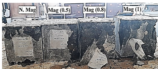
شکل ۶- الگوی شکست نمونه‌های بتن تحت شدت‌های مختلف میدان مغناطیسی
