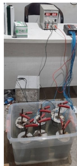
شکل ۴- دستگاه مورد استفاده برای خوردگی تسریع شده میلگردهای فولادی مدفون در بتن
