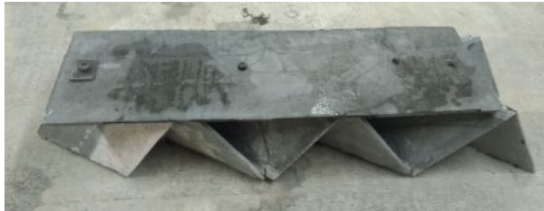
شکل ۷- اتصال صفحه‌ی زیرین به هسته با پیچ
