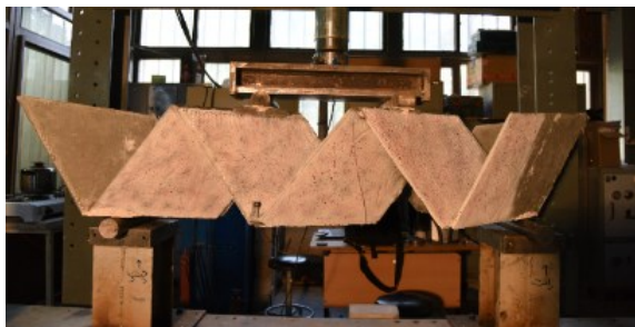
شکل ۸- آزمایش خمش چهار نقطه‌ای نمونه‌های بزرگ مقیاس
