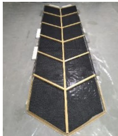
(الف) پهن کردن پارچه‌ی سه بعدی و قرار دادن فضا نگه دار در شیارها
