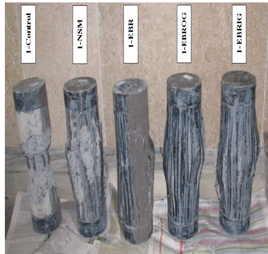
شکل ۴- نحوه شکست نمونه‌ها در تقویت به روش‌های مختلف
